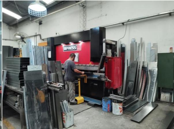
**Plegado:** se trasladan manualmente chapas del área de corte y/o de depósito y se procede al plegado en máquina plegadora.
