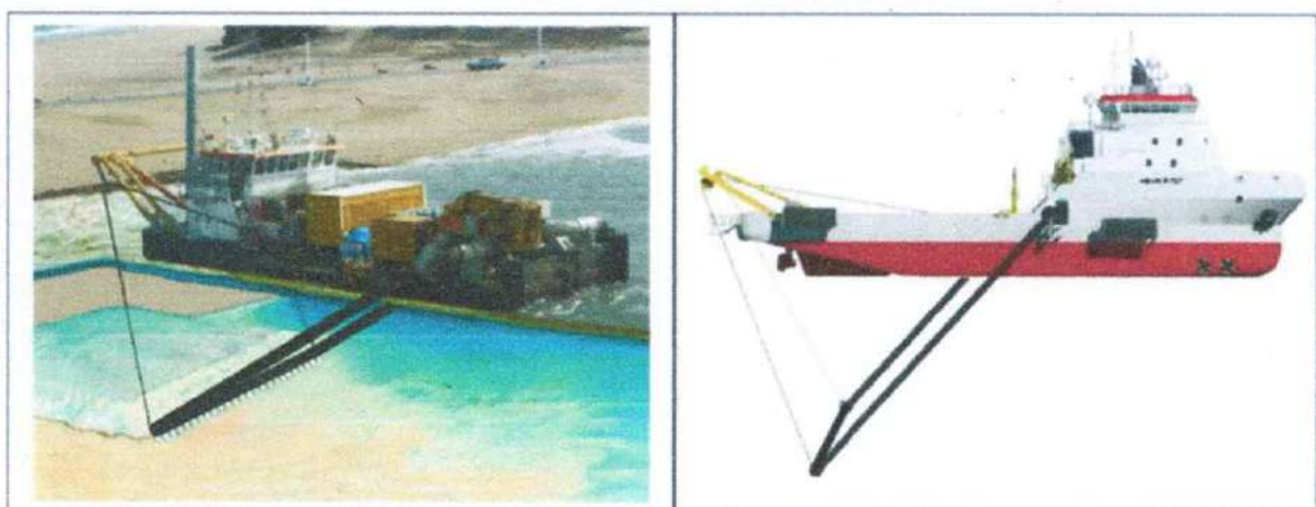
Figura N°20: Sistema de Inyección de agua "jetting" izq. DN28 der H. Pitot
