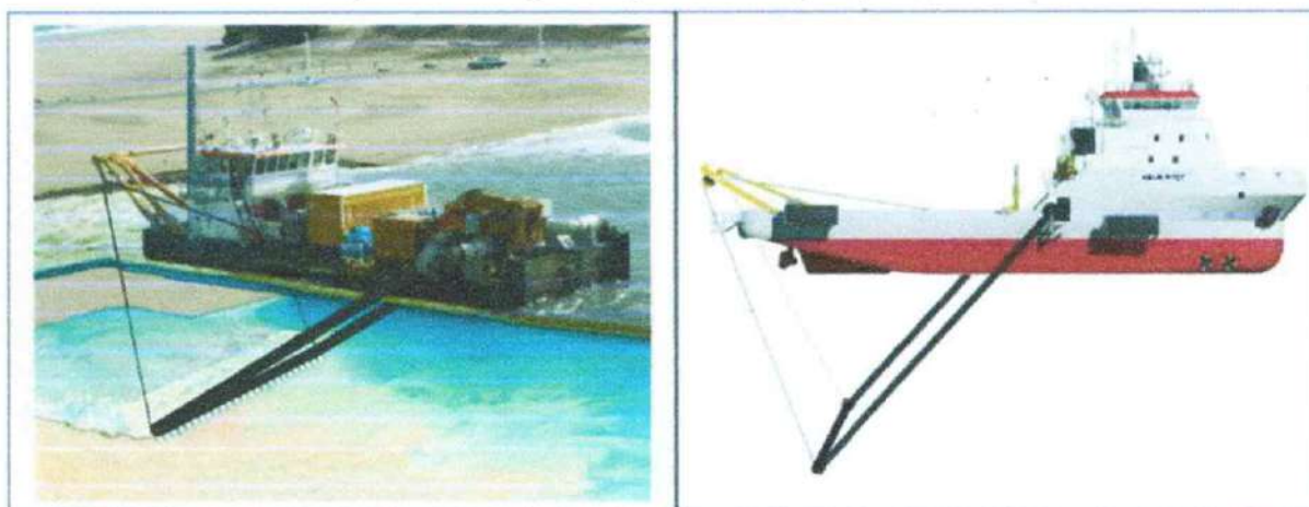
Figura N°8: Sistema de Inyección de agua "jetting" izq. DN28 der H. Pitot
