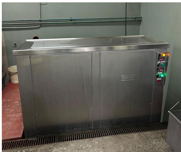
*Imagen N°1: Equipo de ultrasonido, sector de galvanoplastia*
