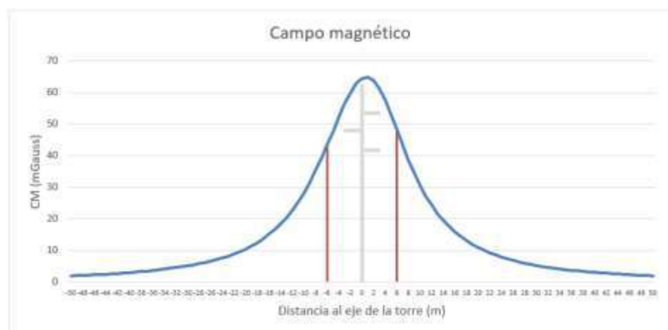
Figura 10 - Campo magnético en función de la distancia
