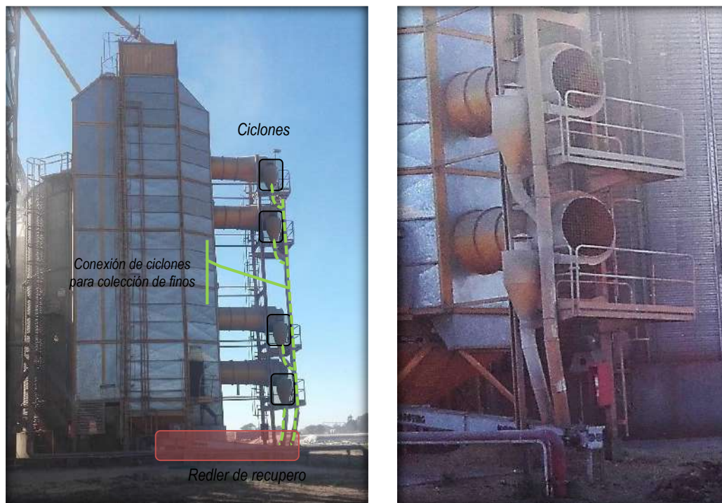
Secadora de granos y detalle de ciclones con conexiones para colección de finos.
