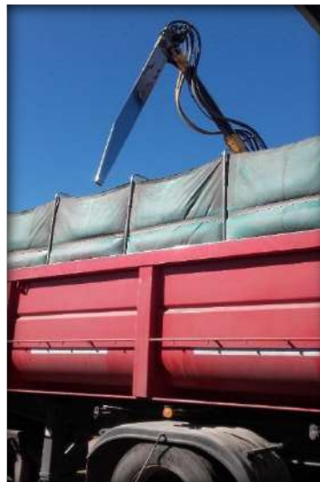
Vista del calador automático.
