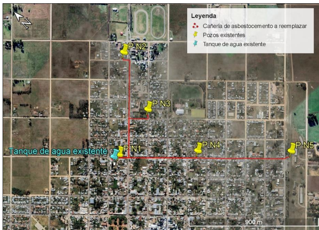
Figura 1: Pozos y tanque de almacenamiento en el sistema existente.
