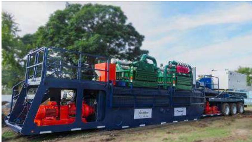
Foto 2-1. Equipo Reciclador de fluidos con desarenadores y centrifugas Derrick de 600 GPM.
