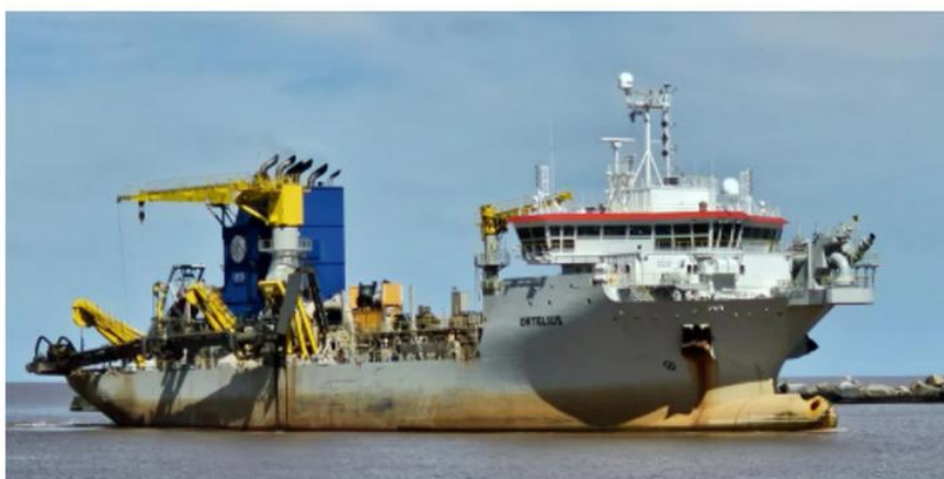
Fig. 2.2: Draga tipo TSDH del tipo a utilizar
