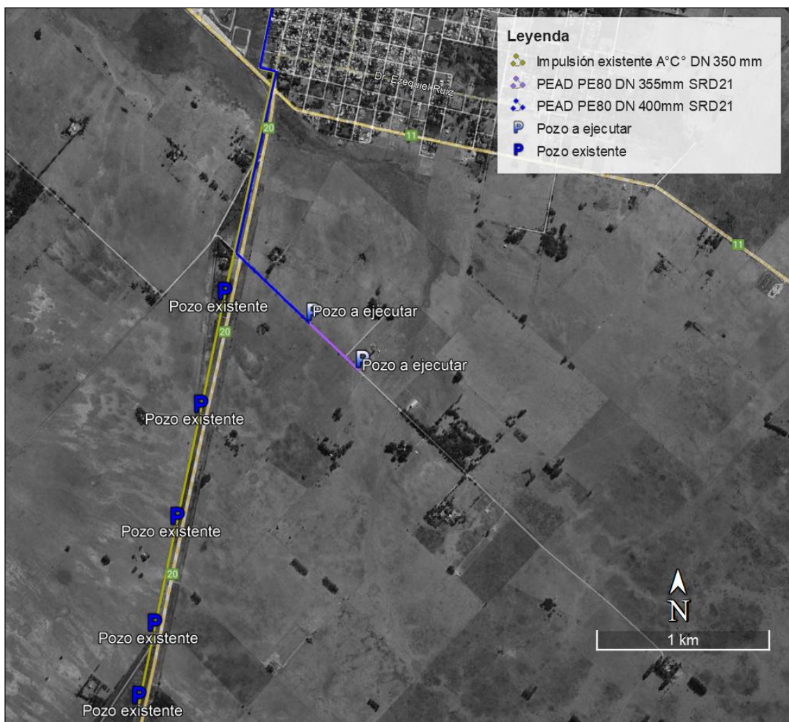
Figura 2 Pozos existentes y a ejecutar
