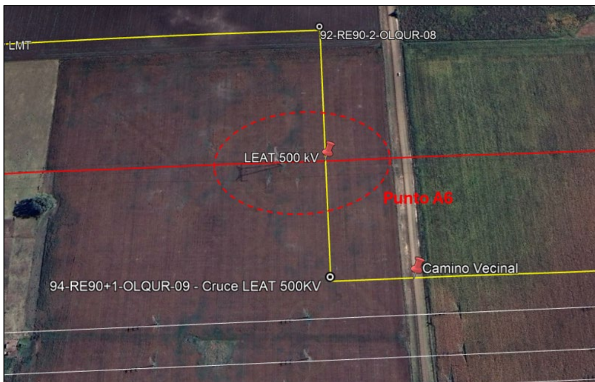
Gráfico 26. Punto de cálculo en traza de nueva LAT 132kV cruzando LEAT 500kV 5BBOL1
