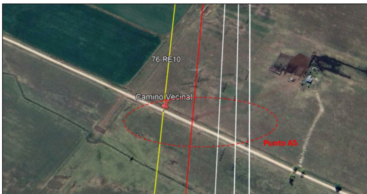
Gráfico 21. Punto de cálculo en traza de nueva LAT 132kV cercana a líneas 132kV 1LCH-OL1, 1OL-TER1, 1LTOL1, 1BKD-OL1, 1CL-OL1 y 1LN-OL1 y LEAT 500kV 5BBOL1
