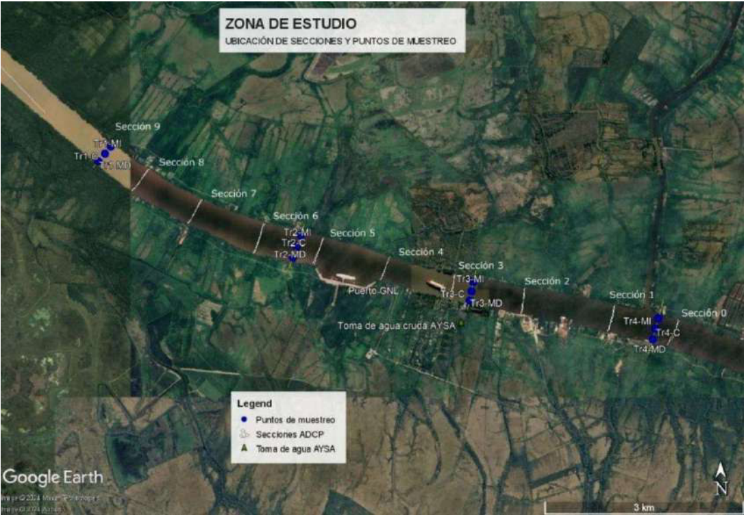
Imagen correspondiente a la Ubicación del tramo bajo estudio, secciones relevadas con ADCP y puntos de muestreo de material de fondo y calidad de agua. (FICH, 2024)
