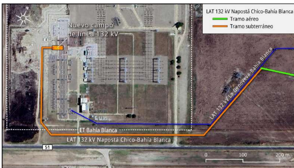
Figura 3. Vista de la acometida a ET Bahía Blanca.
