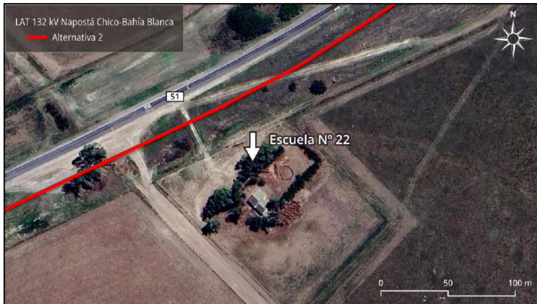
Figura 2. La Alternativa 2 (Roja) pasa frente a la escuela rural N° 22, a menos de 50 m del edificio.
