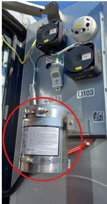
Imagen 3. Sistema activo de supresión de fuego bajo gas.
