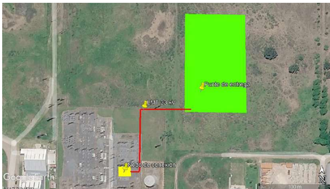
Imagen 4. Vista interconexión eléctrica de la PA Mar de Ajó (línea roja). Fuente. GENNEIA S.A.
