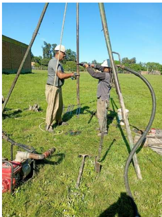
Fotos 3.13, 3.14. vista del avance en la realización de calicatas para el estudio de suelo.
