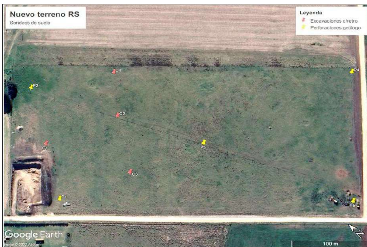
Figura 8.1. Ubicación de cateos y sondeos realizados (Fuente Informe sondeos con excavadora cat 215d).
