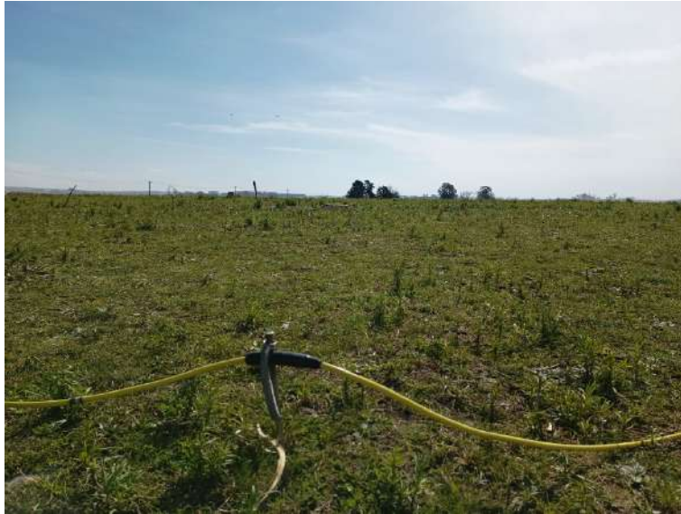
Figura D.3. Contacto electrodo estaca, correspondiente a la disposición en campo de las tomografías de resistividad eléctrica.
