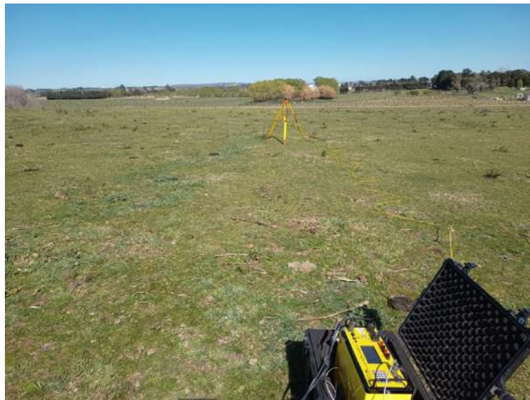
Figura D.6. Disposición en campo de la etapa correspondientes a las tomografías de resistividad eléctrica, mostrando la nivelación mediante nivel óptico y mira de la línea relevada.
