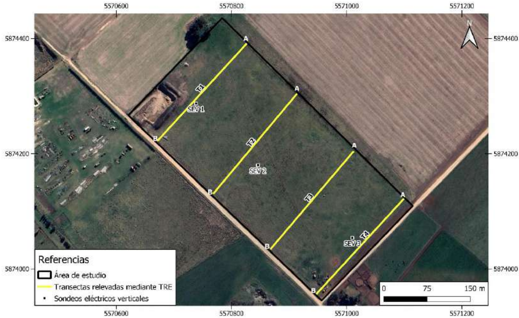
Figura 6. Ubicación de las transectas relevadas mediante Tomografías de Resistividad Eléctrica. La notación A indica el inicio y la notación B indica el fin de las transectas, haciendo referencia a los electrodos 1 y 56 respectivamente.
