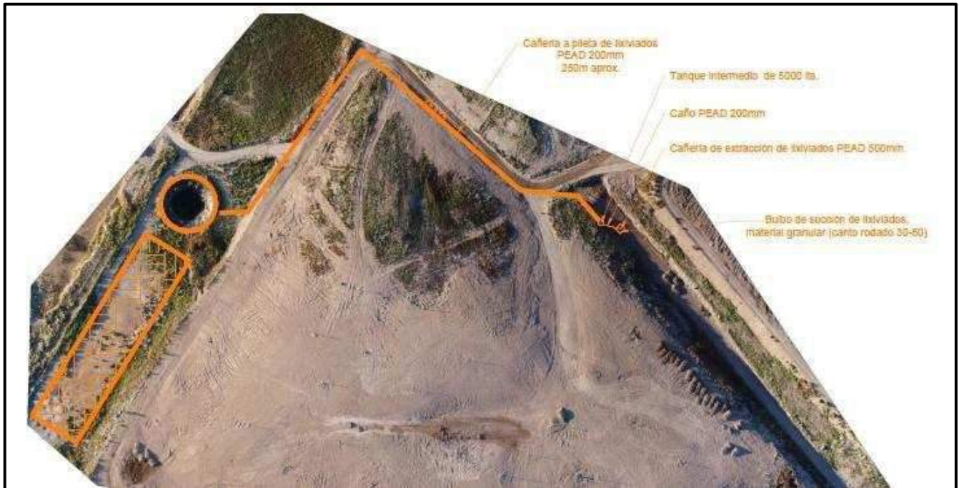
Figura N°5: Sistema recolección y acopio lixiviados
