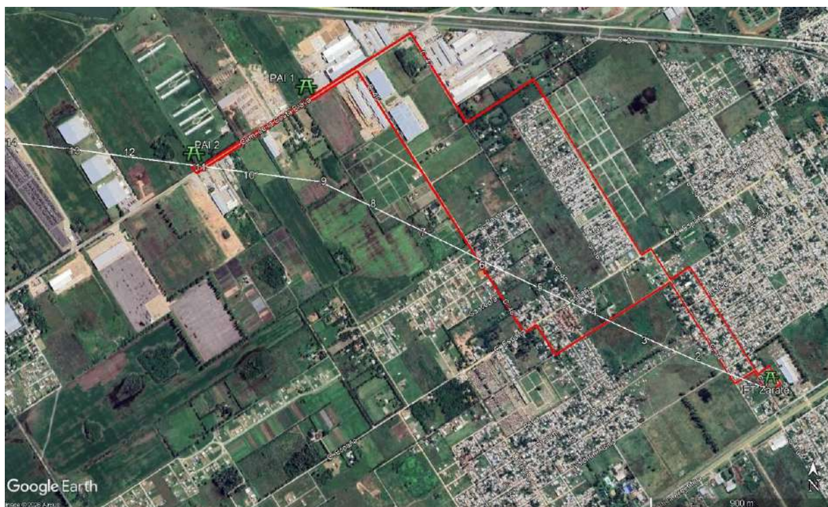
Figura 3.25 Traza de la LAT 1LSZA1 en la zona de proyecto (línea blanca). Los piquetes involucrados son los numerados entre 1 y 11. El soterramiento se indica en línea roja.
