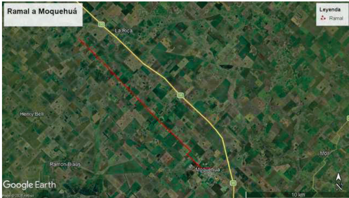
Figura 3.6-1. Croquis del ramal a Moquehuá de 18.400 m.
