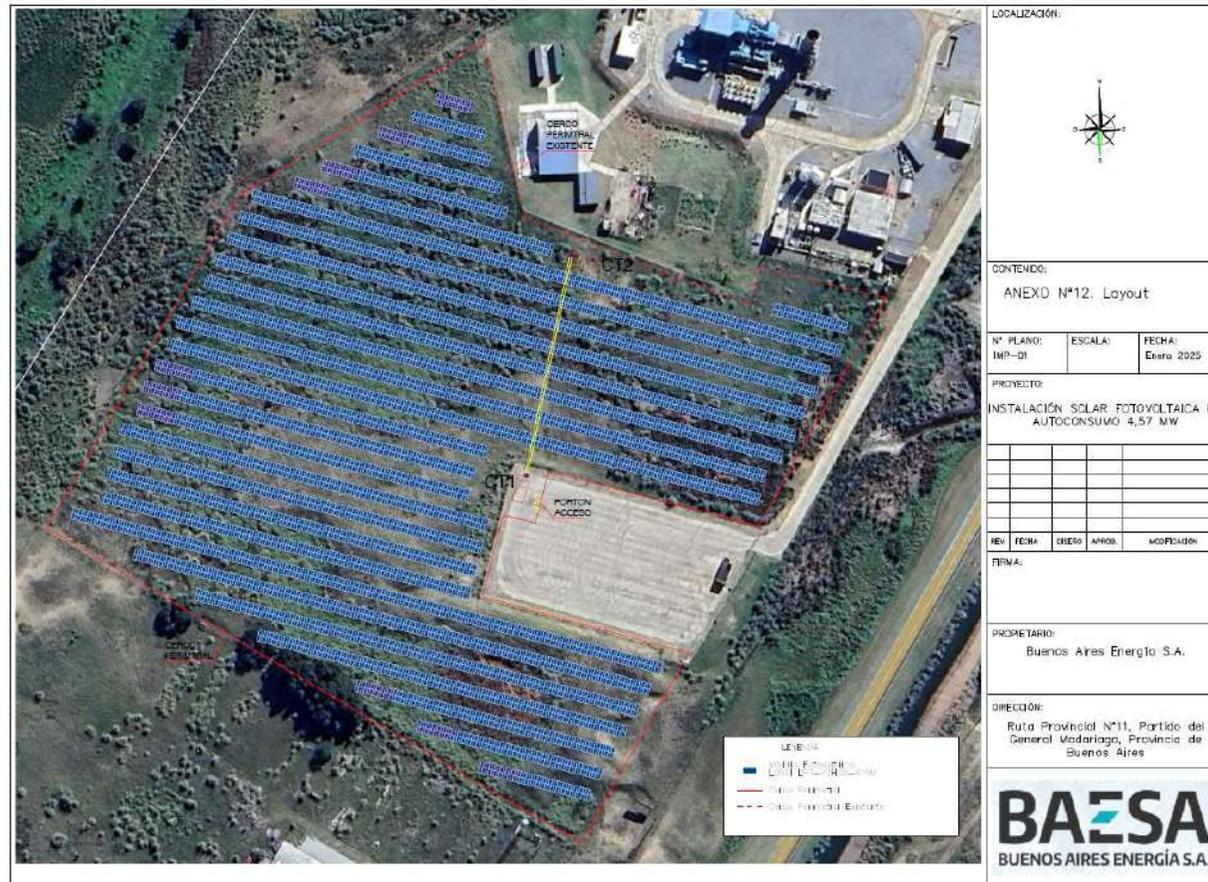
Imagen 16 Disposición de las instalaciones dentro del predio del proyecto (límite de terrenos en verde). Ver Anexo para más detalles. Fuente: RED – HAIN ENERGIA.SRL
