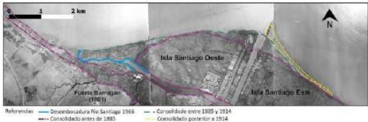
FIGURA N° 34 ANÁLISIS SERIADO DE MATERIALES TOPOGRÁFICOS, AEROFOTOGRAFÍAS Y SATELITALES QUE PERMITEN RECONSTRUIR LA PORCIÓN FINAL DE LA ENSENADA DE BARRAGÁN. LAS LÍNEAS DE COLORES REPRESENTAN LOS DISTINTOS PERIODOS DE CONSOLIDACIÓN DE LAS DIFERENTES UNIDADES MORFOLÓGICAS.<sup>17</sup>
