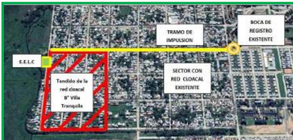
FIGURA N° 6 - SISTEMA DE LA RED CLOACAL – ESTACIÓN DE BOMBEO – CAÑERÍA DE IMPULSIÓN<sup>5</sup>
