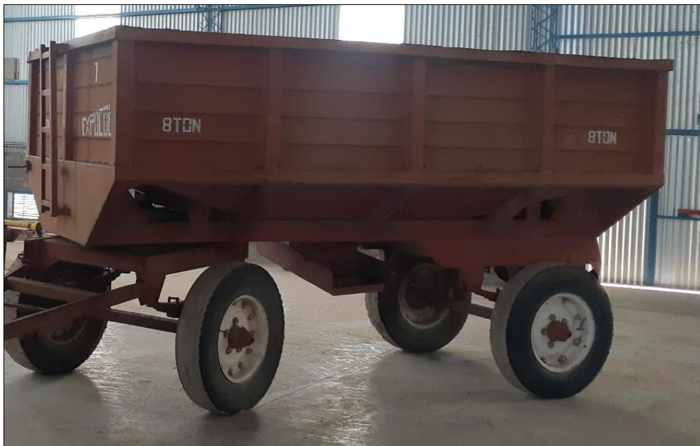
Imagen 33: Carro de dos ejes con 8 Ton de capacidad.
