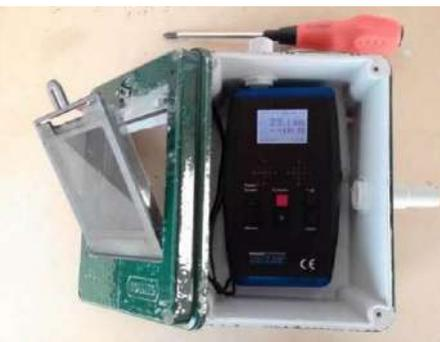
e) Equipos detectores de ultrasonido y grabadora utilizados en las estaciones fijas de escucha
