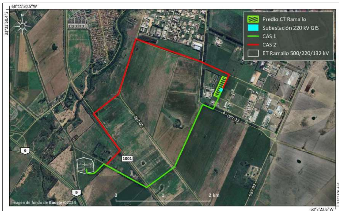
Figura 1. Alternativas de traza evaluadas: CAS 1 (verde) con 4.500 m de extensión y CAS 2 (roja) con 6.500 m
