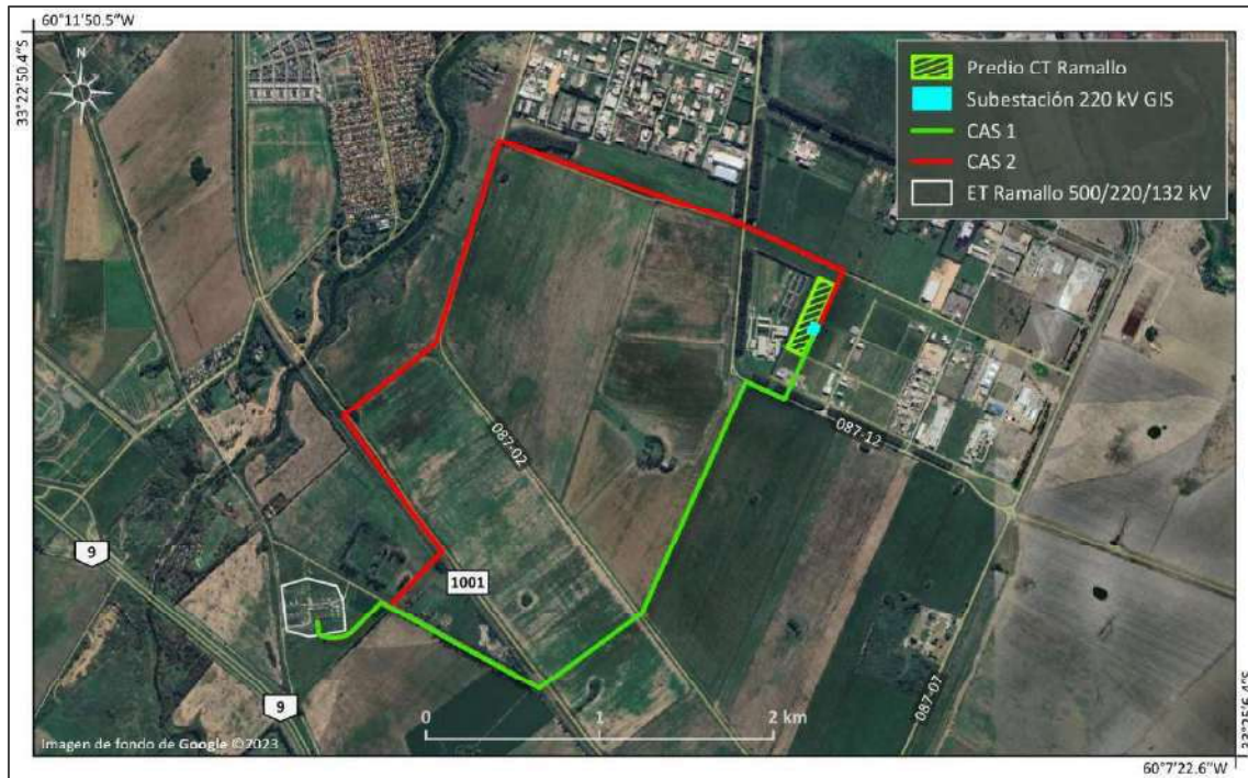
Figura 36. Imagen satelital de la central Termoeléctrica Ramallo donde se muestra: Las trazas propuestas para el CAS 220 kV de vinculación eléctrica (CAS 1 traza verde y CAS 2 traza roja), la nueva Subestación 220 kV GIS (polígono celeste) en el predio de la Central Termoeléctrica (rectángulo verde) y la Estación Transformadora 500/220/132 kV Ramallo de Transener SA (polígono blanco), lugar de acometida del CAS 220 kV.
