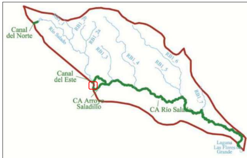
Figura 24: Trazas de las obras propuestas por el INA (2012) para reducir el riesgo y mitigar los efectos de las inundaciones. CA: canalización. Recuadro rojo: ubicación relativa del Proyecto.
