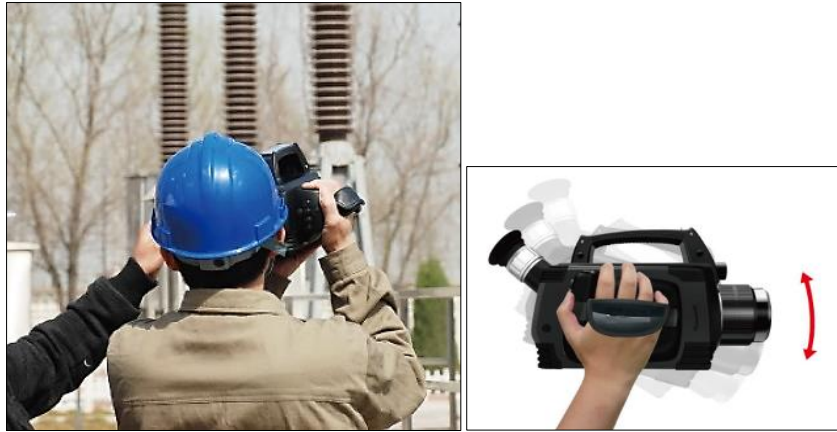
Figura 6-3. Adquirir equipos de detección de fugas de gas SF 6
