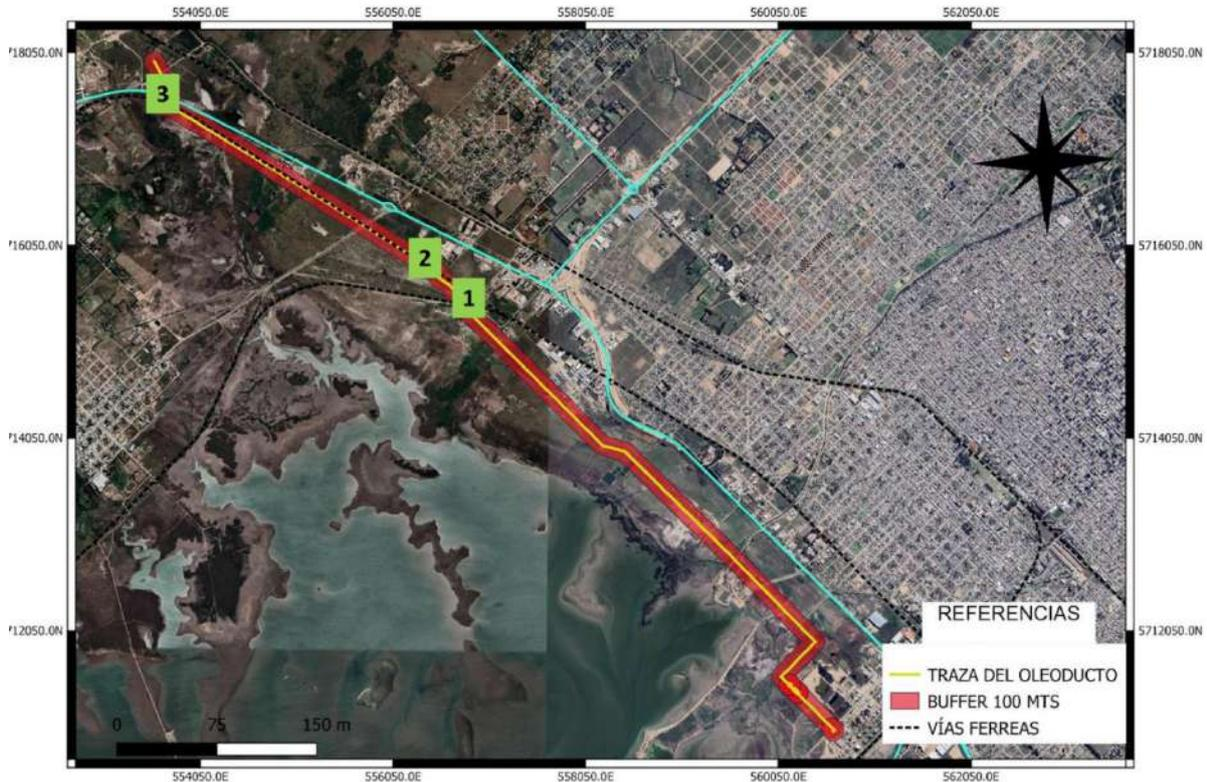
**Figura 55. Intersección de la traza con las vías férreas (línea punteada negra). Como se observa, la traza cruza a las vías férreas en tres puntos. Los tres cruces se encuentran activos actualmente.**
