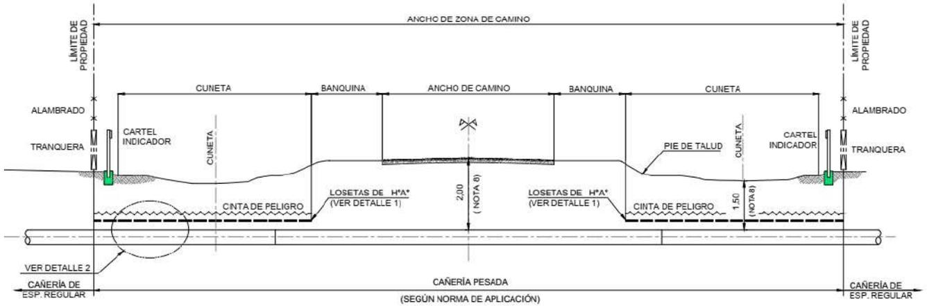
**Figura 8. Vista en elevación del cruce de caminos no pavimentados principales.**
