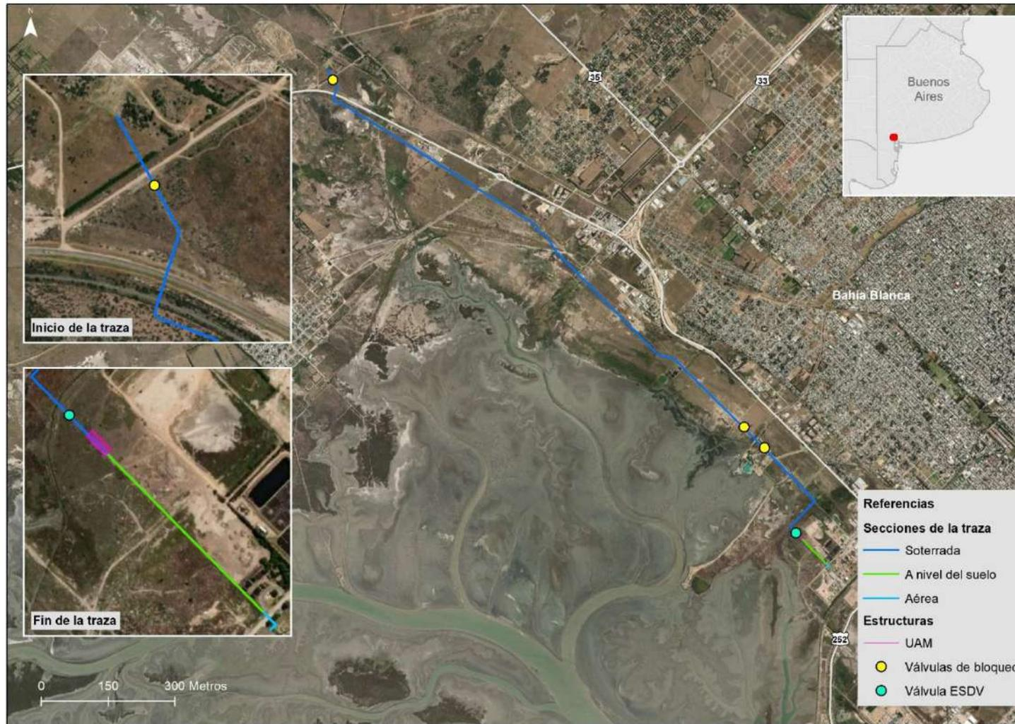
Figura 1. Vista general de la traza del Oleoducto de Derivación a Refinería Trafigura Dr. Ricardo Elicabe.
