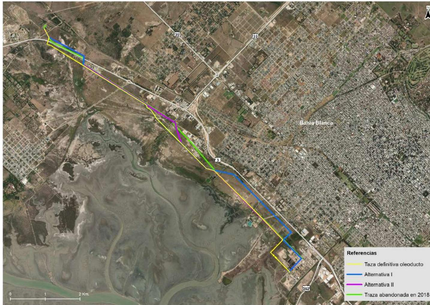
Figura 4. Comparación de alternativas analizadas y traza seleccionada para el Oleoducto de Derivación a Refinería Trafigura Dr. Ricardo Elicabe.
