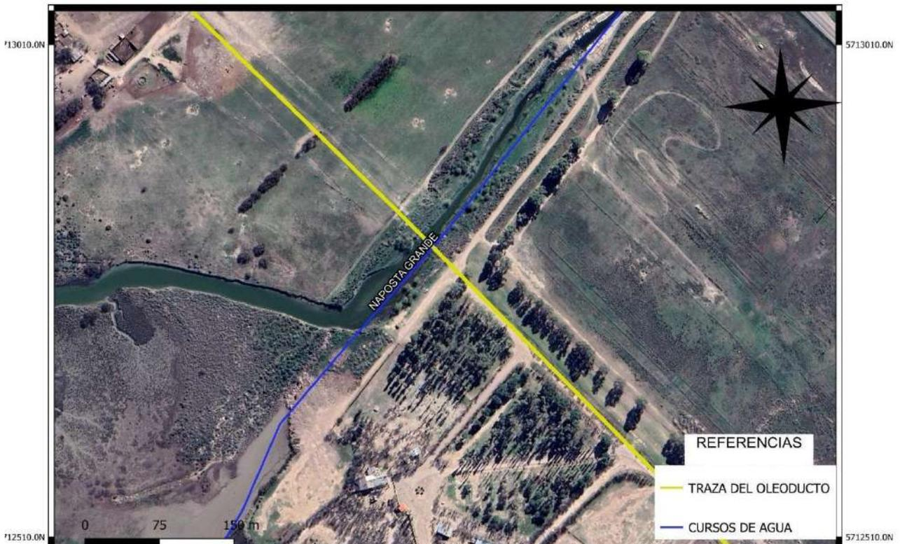
**Figura 64. Intersección de la traza con el canal Maldonado (arroyo Napostá Grande).**
