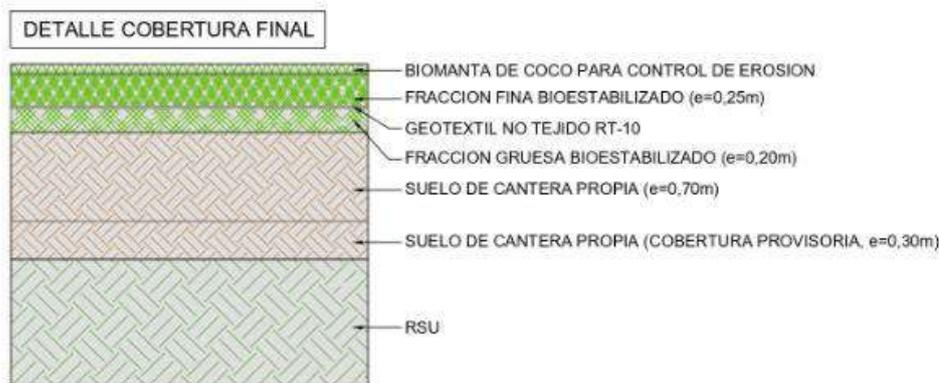
En cuanto a la conformación de esta capa superior de protección y acabado la misma estará conformada por diferentes materiales que se ubican en etapas, con el siguiente esquema de disposición:
