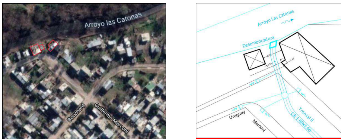
Figura 7. Traza del troncal II en la zona de descarga. Viviendas en Calle Marconi y Uruguay, hacia el A° las Catonas
