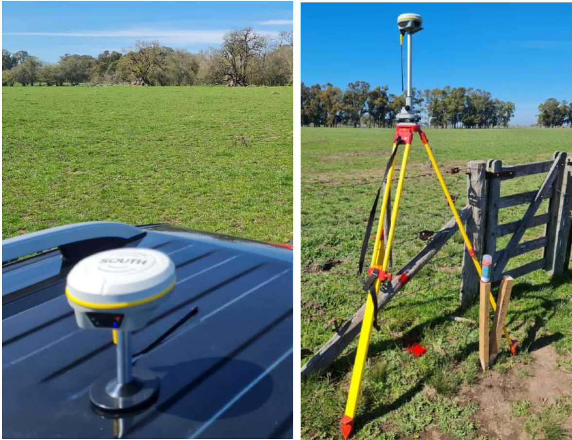
Ilustración 2 – Receptor móvil en techo de camioneta y trípode con receptor base.
