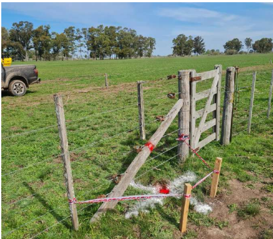
Ilustración 5 - Materialización de punto Fijo – Ver Croquis en siguiente imagen.
