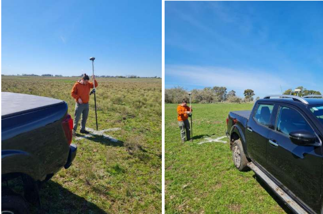
Ilustración 3 - Colocación y relevamiento de PAF.
