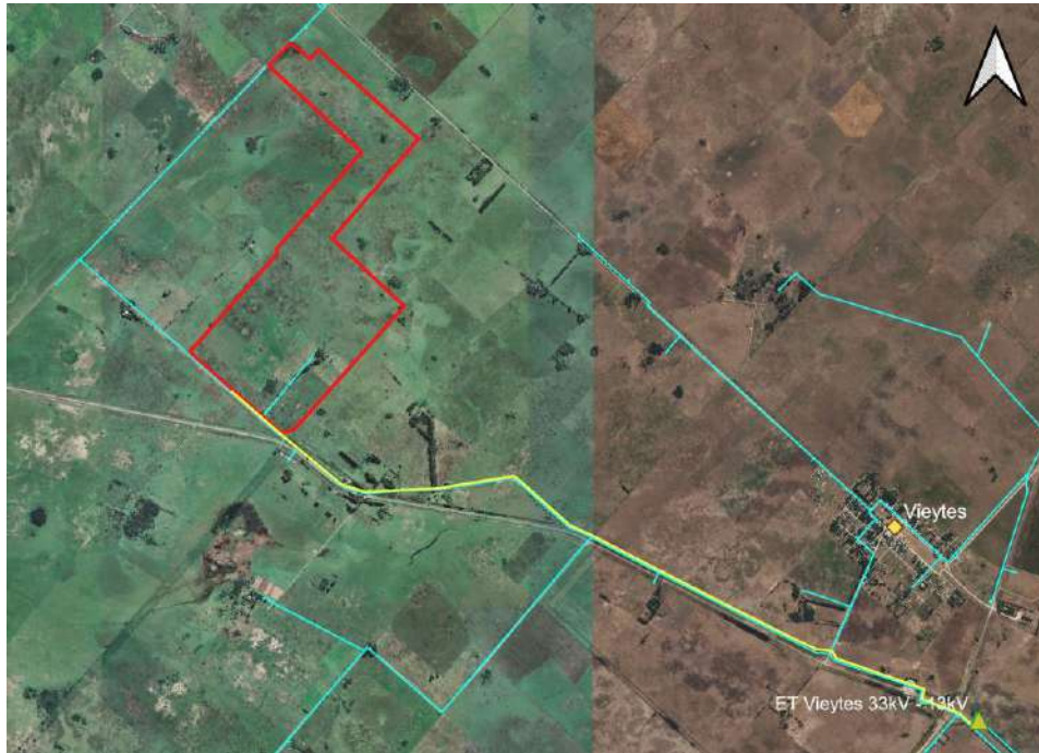
Figura 29 Línea de MT (13,2 kV) que pasa por el predio del proyecto (celeste) y posible traza de la línea de MT (33kV, amarilla)
