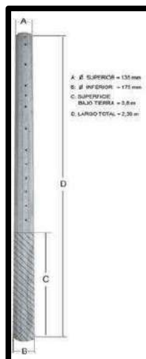
Figura 28 - Poste de hormigón pre-moldeado (indicativo)
