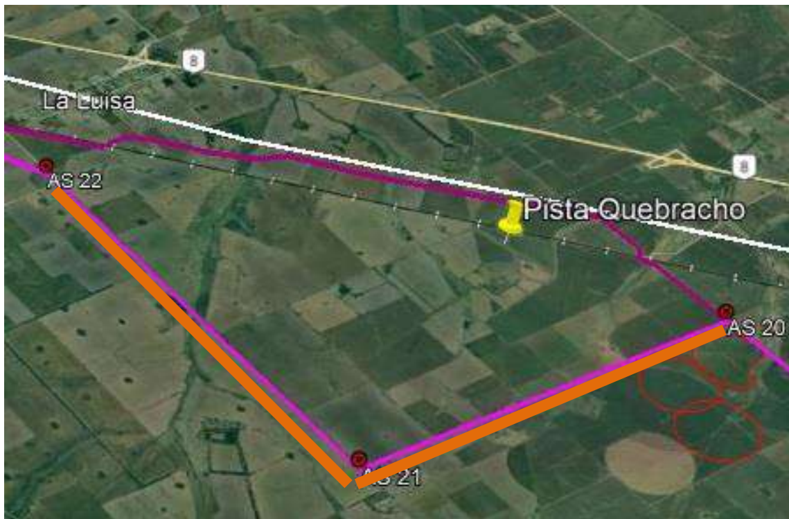
Figura 39 – Traza Alternativa 3 – Tramo modificado por existencia de pista aérea
