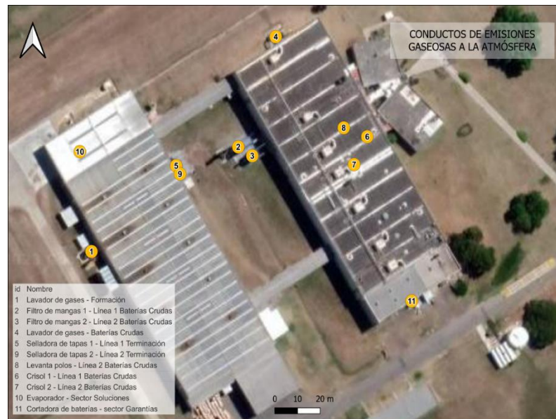
Figura N° 20. Localización de los conductos de emisiones gaseosas a la atmósfera
