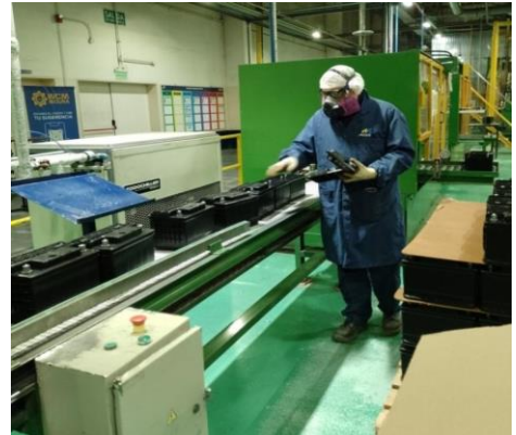
Figura Nº 5. Colocación de tapas
