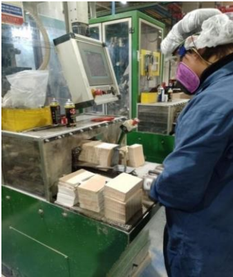
Figura Nº 3. Colocación de placas de plomo
