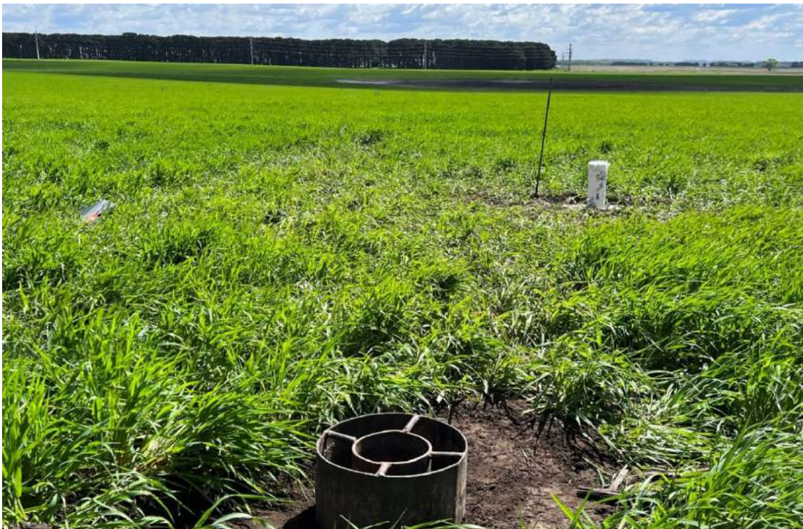
LBA. Ensayo de infiltración en suelo
