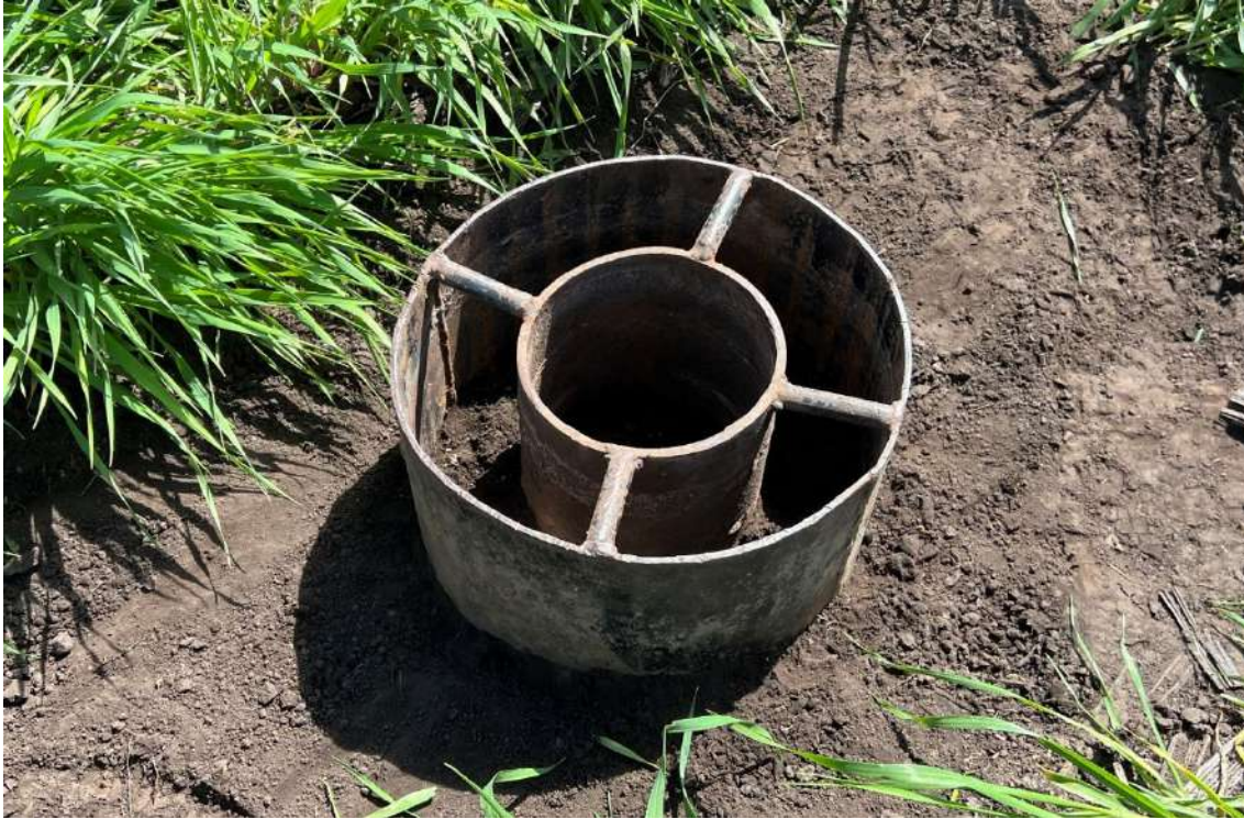
LBA. Ensayo de infiltración en suelo
