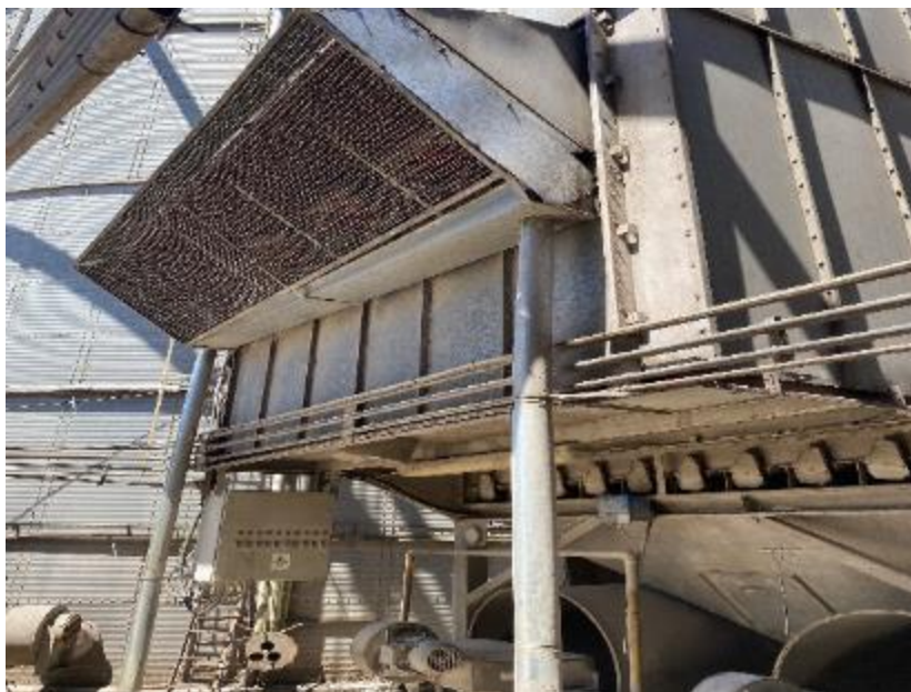
Imagen 6: aspiraciones en salida de aire húmedo de la secadora
