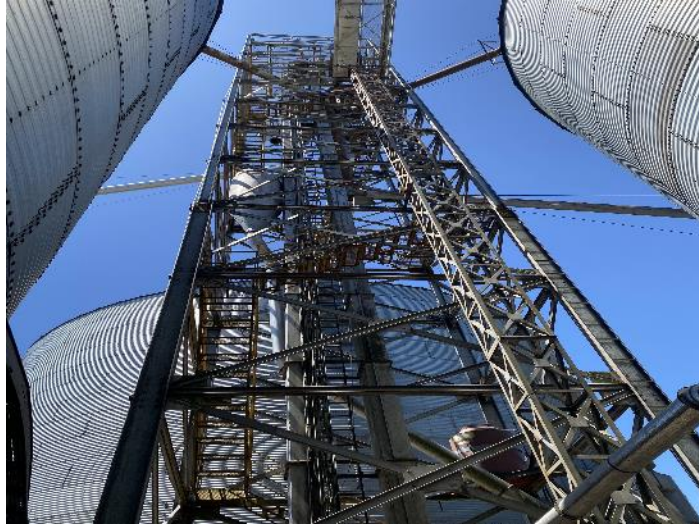
Imagen 8: separador ciclónico de noria
