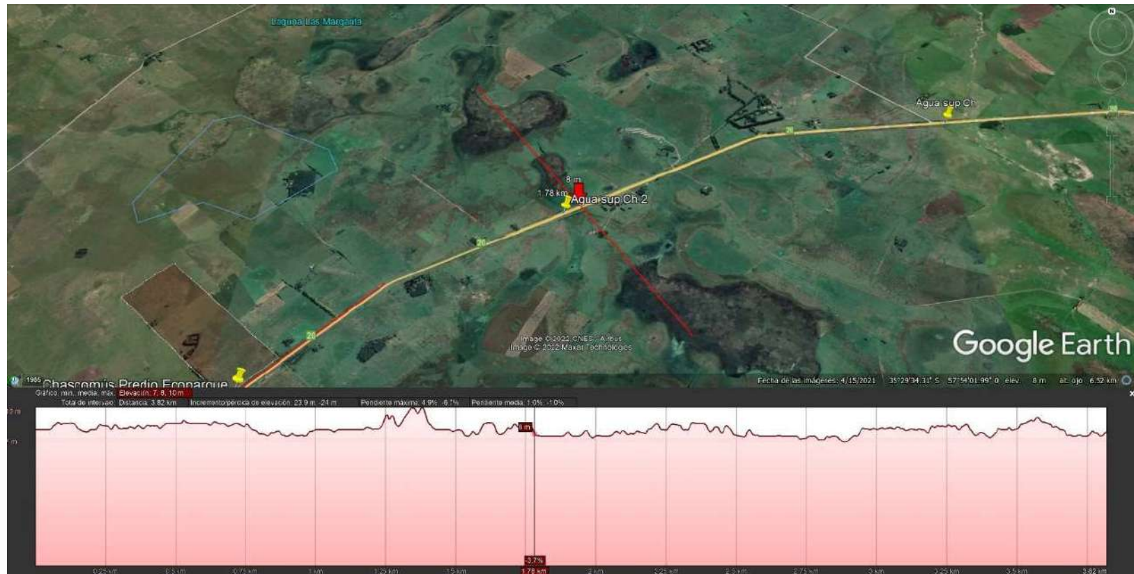
Imagen 22. Perfil de elevación de transecta perpendicular a la ruta N° 20 a la altura de la alcantarilla hacia la laguna Las Margaritas.
