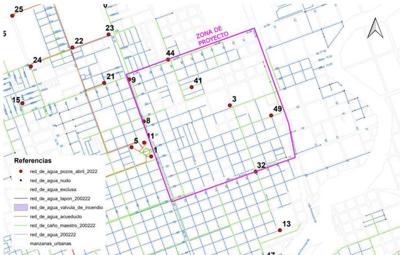
Figura 35: pozos de la red urbana en zona de proyecto.
